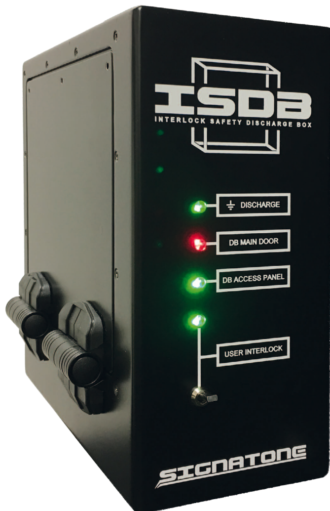
Bild 3 Interlock Safety Discharge Box des Proberherstellers Signatone
