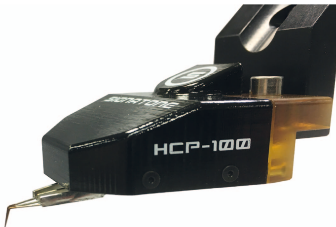
Bild 2 Beispiel einer High Current Probe
