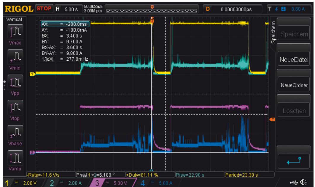
Bild 4: Abschalten des leistungsschwächeren Netzteils durch kurzzeitigen Peakstrom von knapp 10 A auf der 12 V Strecke. (gelb = 5 V Spannung, türkis = 5 V Strom, pink = 12 V Spannung, blau = 12 V Strom).
