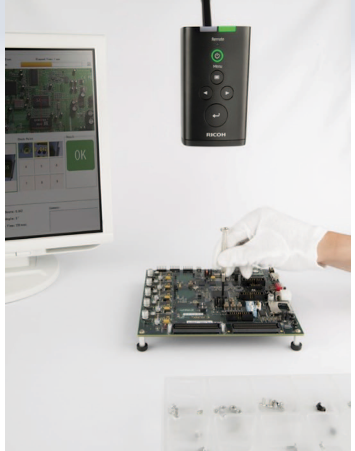
Leiterplattenbestückung mit dem "Human-Assistance"-Kamerasystem Ricoh SC-10 (Bild: Ricoh)
