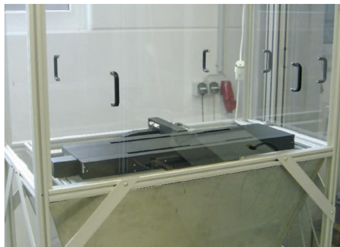
Messung nach der Ganzheitsmethode: Das Messobjekt befindet sich in einer Messzelle, an deren unterem Ende in einem Trichter die Partikel und der Volumenstrom gemessen werden
