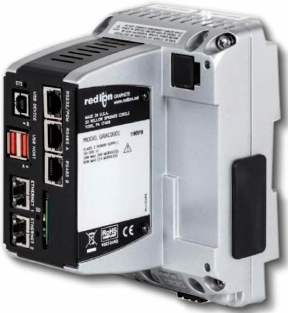
Bild 1: Protokollkonvertierer, der mehr als 300 industrielle Protokolle unterstützt, um verschiedenartige Geräte nahtlos miteinander kommunizieren zu lassen. ©redlion
