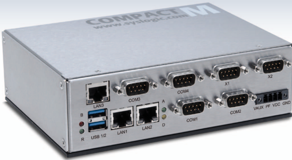
Der Industrie-PC Compact M8 wurde für den Einsatz in Fahrerlosen Transportfahrzeugen (FTS) oder in Logistiksystemen entwickelt
