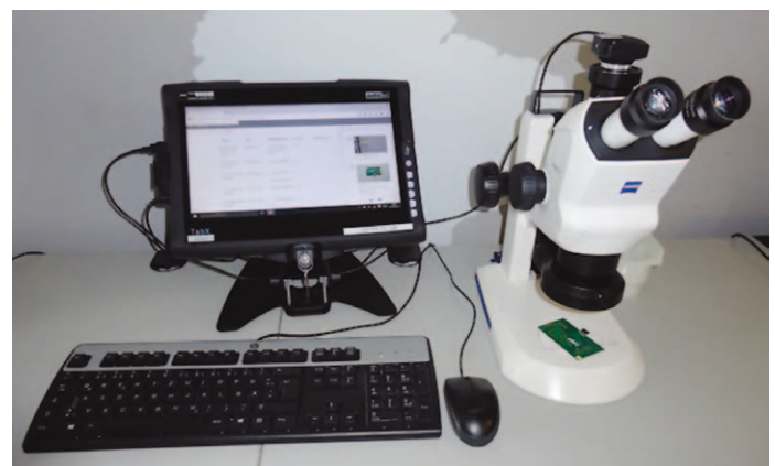
Bild 2: Arbeitsplatz zur optischen Inspektion von Leiterkarten mit Anbindung an die App „Produkte“ (Bild Carl Zeiss 3D Automation GmbH)
