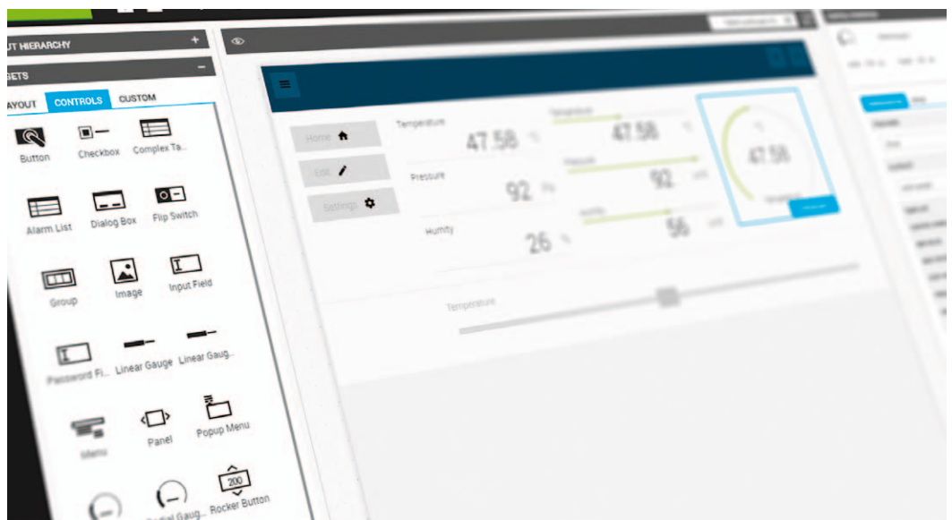
Bild 6: Engineering Umgebung zur Erstellung von Web-HMIs ohne HTML- und JavaScript-Kenntnisse (Bild Smart HMI GmbH)
