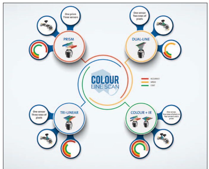
Bild 2: Farbzeilensysteme lassen sich in vier Hauptgruppen einteilen. Jede dieser Methoden bringt ihre ganz spezifischen Vorteile mit. Anhand der Balkendiagramme lassen sich Kosten, Geschwindigkeit und Genauigkeit für jede dieser Technologien schnell vergleichen
