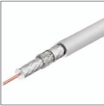
Bild 2: Das Koaxkabel 125 HD ist dreifach geschirmt und bietet daher extrem hohe Störsicherheit für Fernsehverteilanlagen in Häusern oder in multimedialfähigen BK-Netzen
