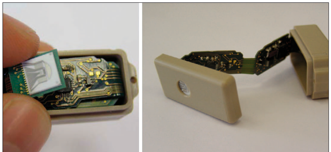
Bild 2: Intelligentes Implantat im geöffneten Zustand. Die faltbare Elektronik incl. Sendeeinheit, um Daten nach außerhalb des Körpers zu senden, ist gut zu erkennen
