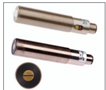
Bild 3: Laser-System mit Verschmutzungskompensation (oben Empfänger PE180122, unten Sender PS180022). Durch die Integration von Schlitzblenden im Sender und Empfänger wird der Lichtstrahl für spezielle Messaufgaben fokussiert
