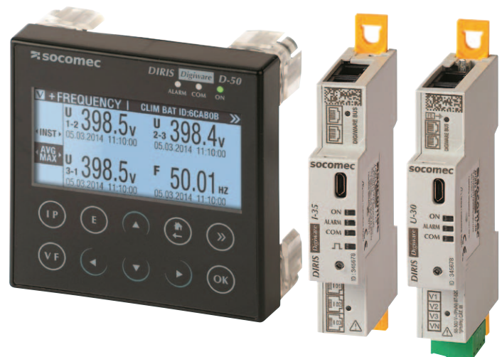
Die Messlösung Diris Digiware lässt sich bedarfsgerecht aus Stromsensoren, Strommessmodulen, Spannungsmessmodul und Anzeigegerät zusammenstellen. In Bestandssystemen reduzieren teilbare Sensoren den Aufwand für die Nachrüstung
