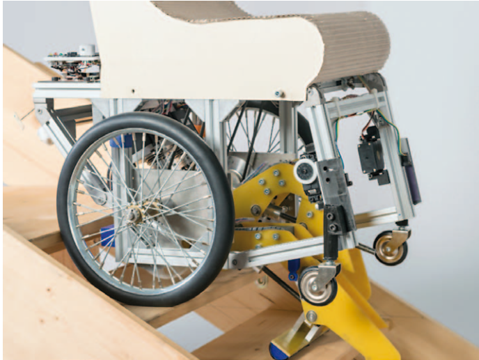
Am bionischen Rollstuhl sind zwei „Füße“ angebracht, die das Treppensteigen möglich machen (Foto: Uli Benz / TUM)
