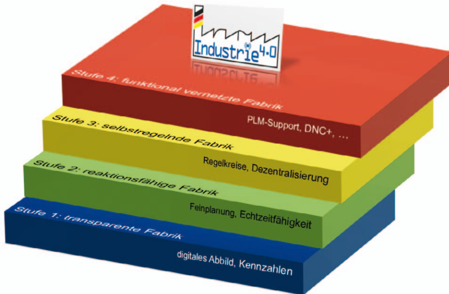
Bild 1: Vier-Stufen-Modell: Schritt für Schritt zur „Smart Factory“. Anforderungen an das Unternehmen (die Fabrik) werden in Stufen gruppiert und durch definierte Funktionen (rechts) unterstützt
