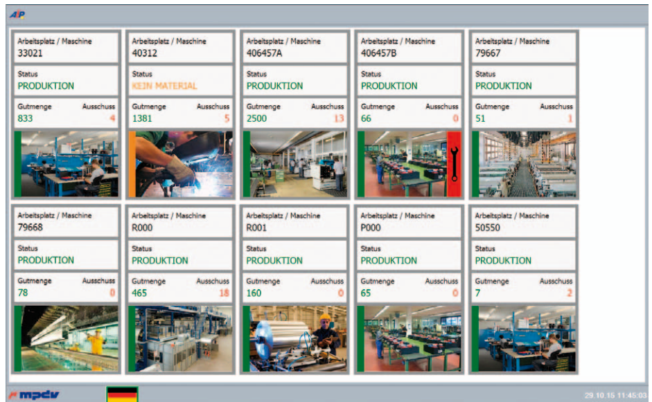
Bild 3: Intuitive Oberfläche im HYDRA-Shopfloor Client zur Darstellung erfasster Maschinen- und Betriebsdaten
