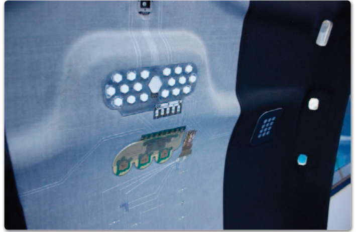
Bild 5a und b Integration der Beleuchtung in den Dachhimmel eines Autos mittels dehnbare und textiler Elektronik
