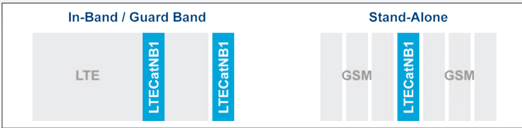
Bild 9: Das NB-IoT-Verfahren LTE Cat-NB1 nutzt einige der über 40 für LTE vorgesehenen lizenzpflichtigen Bänder im Sub-GHz-Bereich. Damit lässt sich eine relativ preiswerte Low-Power-(I)IoT-Funktechnik mit geringer Datenrate und weltweitem Roaming realisieren. Der Vorteil im Vergleich zu LoRa ist, dass die physische Infrastruktur durch das konventionelle LTE-Netz bereits vorhanden ist. Die entsprechenden Basisstationen müssen lediglich mit einer Softwareerweiterung ausgestattet werden. Abzuwarten bleibt, mit welchen Tarifen die Mobilfunkprovider NB-IoT anbieten werden
