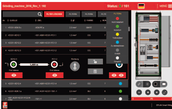
Eplan Smart Wiring visualisiert den Montageaufbau, Betriebsmittel, Verbindungen und Verlegewege, beispielsweise basierend auf den Daten von Eplan Pro Panel, Bilder: Eplan
