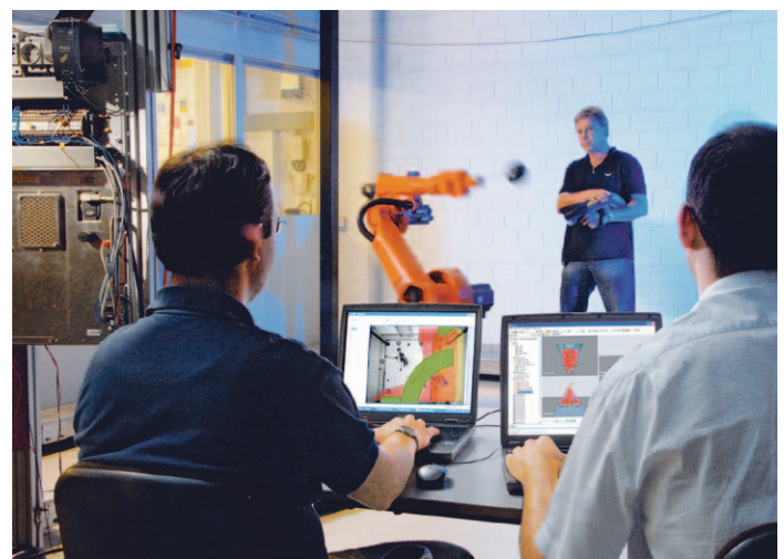
Bild 2: Für MRK werden intelligente Sicherheitssysteme benötigt, wie beispielsweise das 3D-Kamerasystem SafetyEYE, mit dem sich Arbeitsbereiche, in denen Mensch und Maschine kollaborieren, auch ohne trennende Schutzeinrichtungen sicher überwachen lassen
