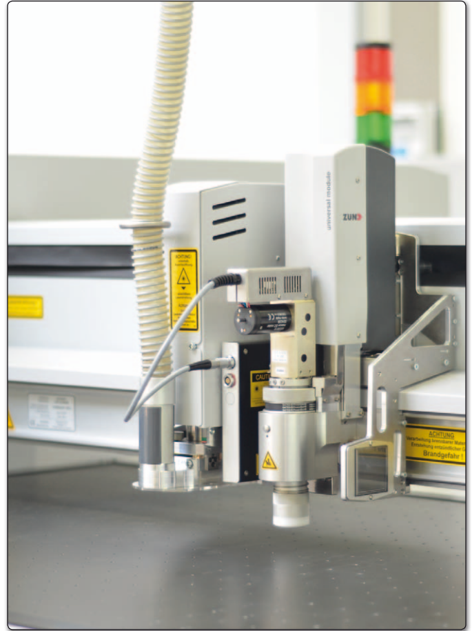
Um flexibel auf Kundenwünsche einzugehen, ist es möglich, auch mechanische Werkzeuge parallel zum Laser zu benutzen
