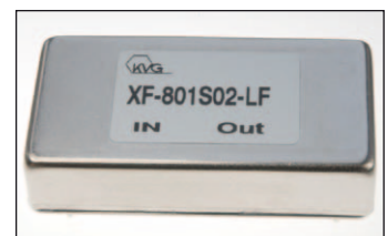
Bild 2: Messobjekt 8-Pol Quarzfilter 37,5 MHz
