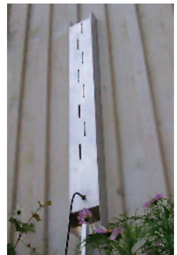
Bild 4: WLAN-Hohlleiter-Sektorantenne mit acht Schlitzen für 2,45 GHz (Quelle: Brennpunkt SRL)
