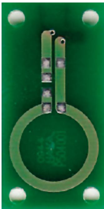
Bild 1: PCB-Antenne Antu-Loop-20-MMCX-F für 867 MHz von MeshedSystems, Abmessungen 40 x 21 x 1,6 mm (4-mm-MMCX-Buchse)
