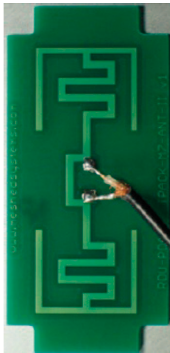
Bild 2: Die PCB-Antenne Antu-PCB-Dip für 867 MHz misst nur 175 x 35 x 1,6 mm (ohne Kabelverbindung) und ist elektrisch verkürzt (induktiv) sowie mit Dachkapazitäten versehen, was den Platzbedarf minimiert. Anschluss über Kabel 30 cm mit MMCX-Stecker (Quelle: MeshedSystems)
