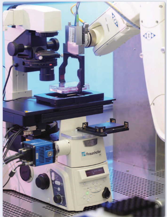
Bild 2: Hochdurchsatz-Mikroskopiesystem: Großflächige Objekte können in Sekundenschnelle mikroskopiert werden. Erstmals ist so eine mikroskopische 100%-Prüfung im industriellen Umfeld möglich (Bild: Fraunhofer IPT)
