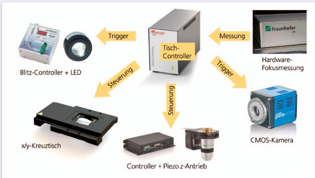
Bild 3: Prinzipieller Aufbau des modular aufgebauten Hochgeschwindigkeits-Mikroskops (Bild: Fraunhofer IPT)
