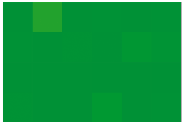
Bild 2: Simulation der Beleuchtung einer Kachelwand mit Toleranzen um \Delta E=3 (Schematische Darstellung)
