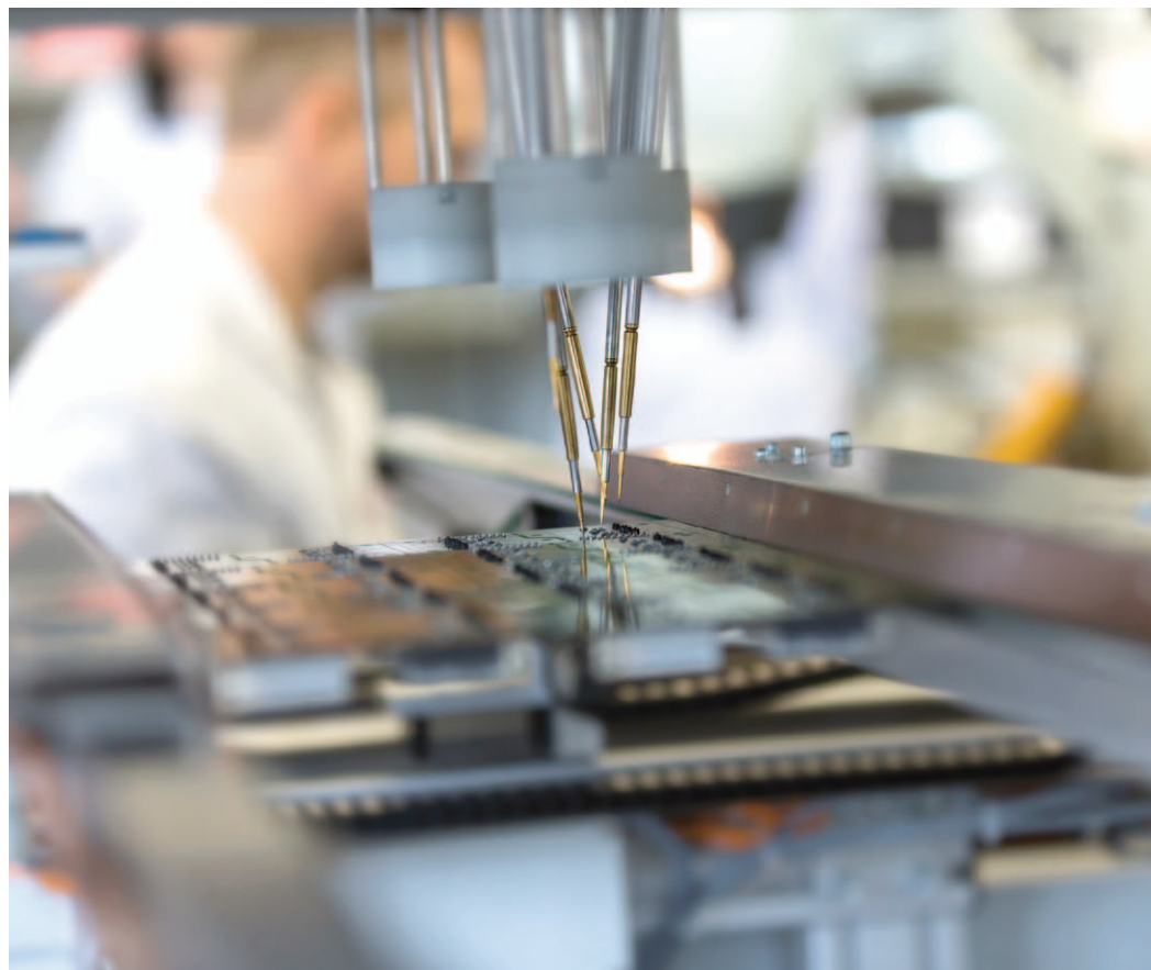
Bild 2: Flying Probe Test mit 9 unabhängig voneinander beweglichen, multifunktionalen Testnadeln
