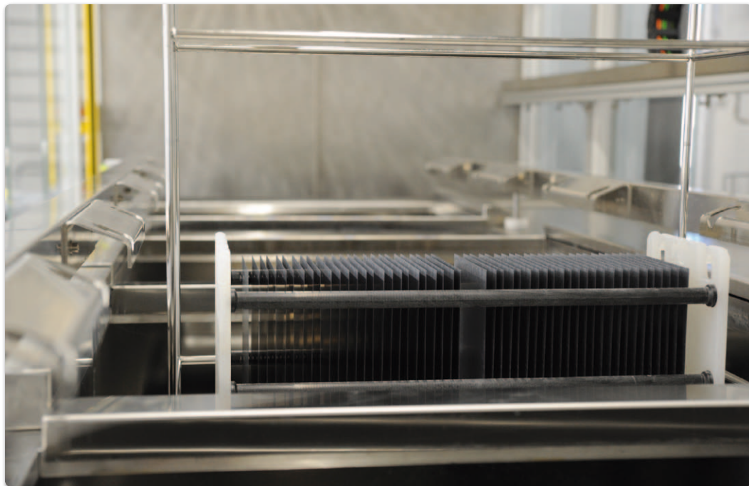
Die Reinigung erfolgt in speziellen Carriern für jeweils 100 Wafer
