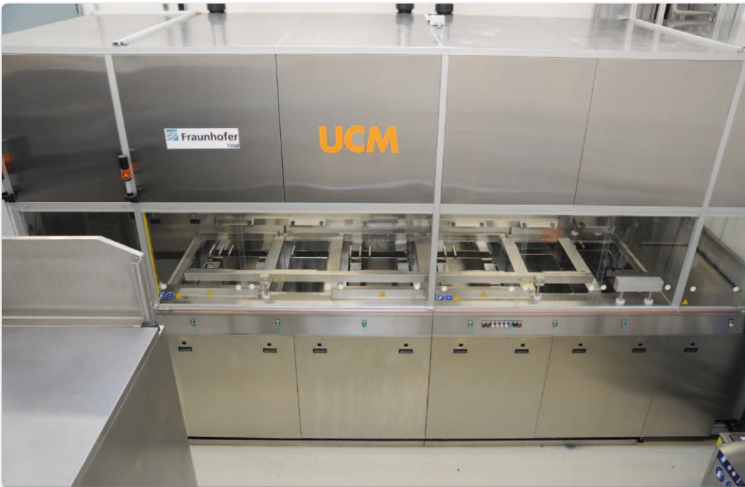
Die Ultraschall-Reinigungsanlage mit sechs Becken wurde exakt auf die zur Verfügung stehende Fläche maßgeschneidert
