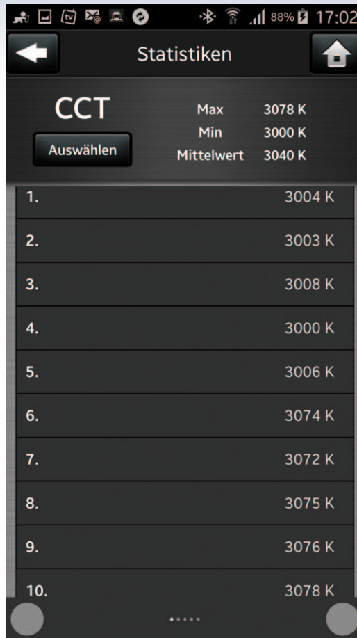
Bild 4+5: Smartphone-Screenshots der Spektrometer-App SGM, rechts die Messergebnis-Ausgabe. Die ersten fünf Messpunkte liegen innerhalb der 3-MacAdam-Ellipse
