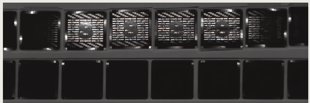
Bild 2: Hologrammstreifen, abgebildet mit einem Zeilenkamerasystem. Hier kommt es zu Verzerrungen, verursacht durch sich ändernde Blickwinkel der Linse
