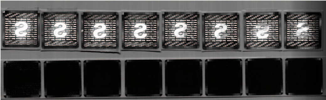
Bild 1: Hologrammstreifen, abgebildet mit einem CIS. Alle Bildelemente sind klar dargestellt (Alle Bilder: Tichawa Vision GmbH)
