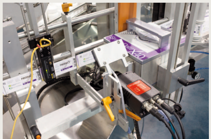
Bild 5: Um die Qualität der Etiketten zu gewährleisten, können Überprüfungs-schritte an jedem Ort der Fertigungsstraße hinzugefügt werden, an dem möglicherweise Fehler entstehen und ein Überprüfungssystem zur Senkung der Kosten beiträgt
