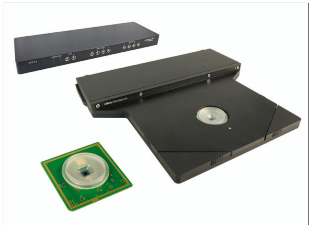
Bild 1: Komponenten des CMOS MEA 5000 Systems. Die beiden schwarzen Din-A4 großen Verstärkerkomponenten enthalten den Neurochip (in der Mitte sichtbar) und verbinden diesen über eine USB3 mit einem Computer. Das Herzstück des Systems ist ein Siliziumchip (im Zentrum der grünen Leiterplatte/PCB), welcher auf eine handlichen Leiterplatte (PCB, grün) gebondet wird und in einer Meßkammer (mattweiss) die zu messenden Zellen oder Gewebe aufnimmt.
