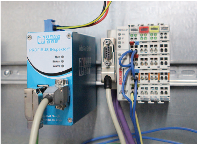
Bild 2: Das Diagnosegerät PROFIBUS-INSPEKTOR gestattet eine umfangreiche Online-Analyse aller qualitätsrelevanten Ereignisse wie zum Beispiel Fehlertelegramme, Wiederholtelegramme, Gerätediagnose-Daten, Neuanläufe und BUS-Zykluszeit. (Bild: Indu-Sol)
