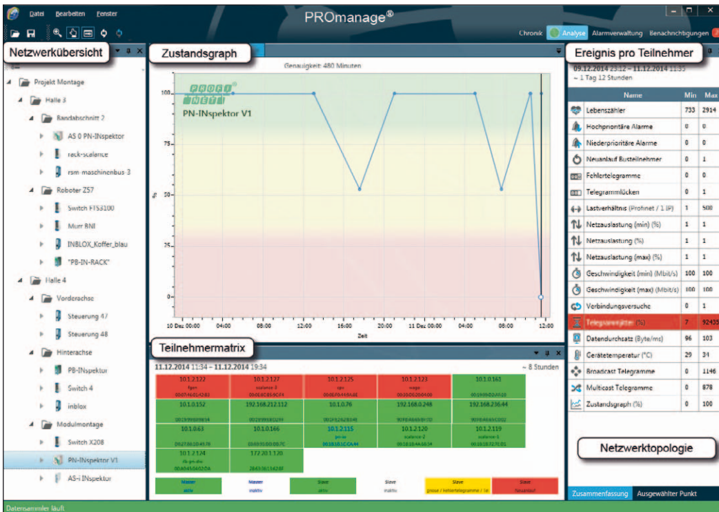
Bild 1: Mit der Software „PROmanage“ lassen sich sowohl Profibus- als auch Ethernet-, Profinet-, CAN-Bus- und ASI-Bus-Netzwerke überwachen. (Bild: Indu-Sol)
