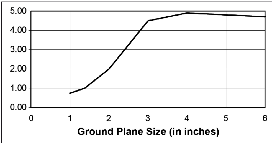
Bild 4: Antennen-Zenit-Gewinn als Funktion der Ground-plane-Abmessungen
