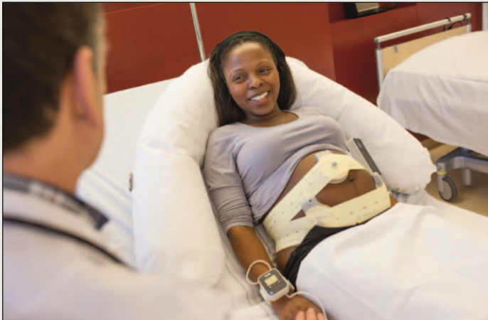
Bild 1: Dieses kabellose Fetalmonitoringsystem kann selbst bei Drillingsschwangerschaften die Herzöne aller Föten synchronisiert erfassen, d.h. mit derselben Impuls-Dichte (Foto: Philips)
