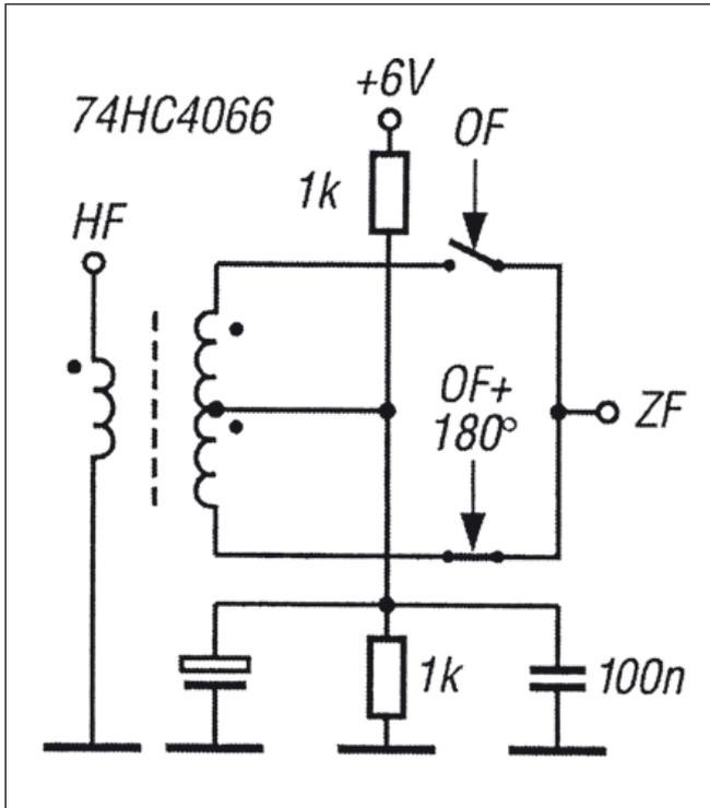
Bild 4.27: Balancemischer mit HCMOS-Schalter-IC
