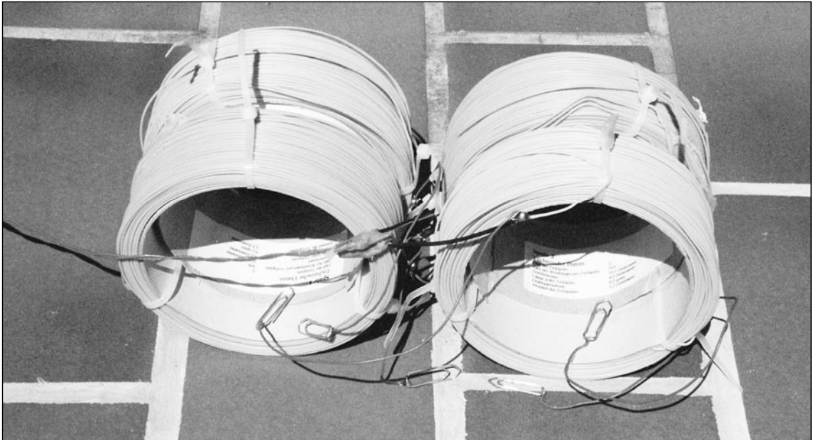
Bild 3: Längstwellenantenne des Autors, bestehend aus der Reihenschaltung von vier Rollen isoliertem Schaltdraht
