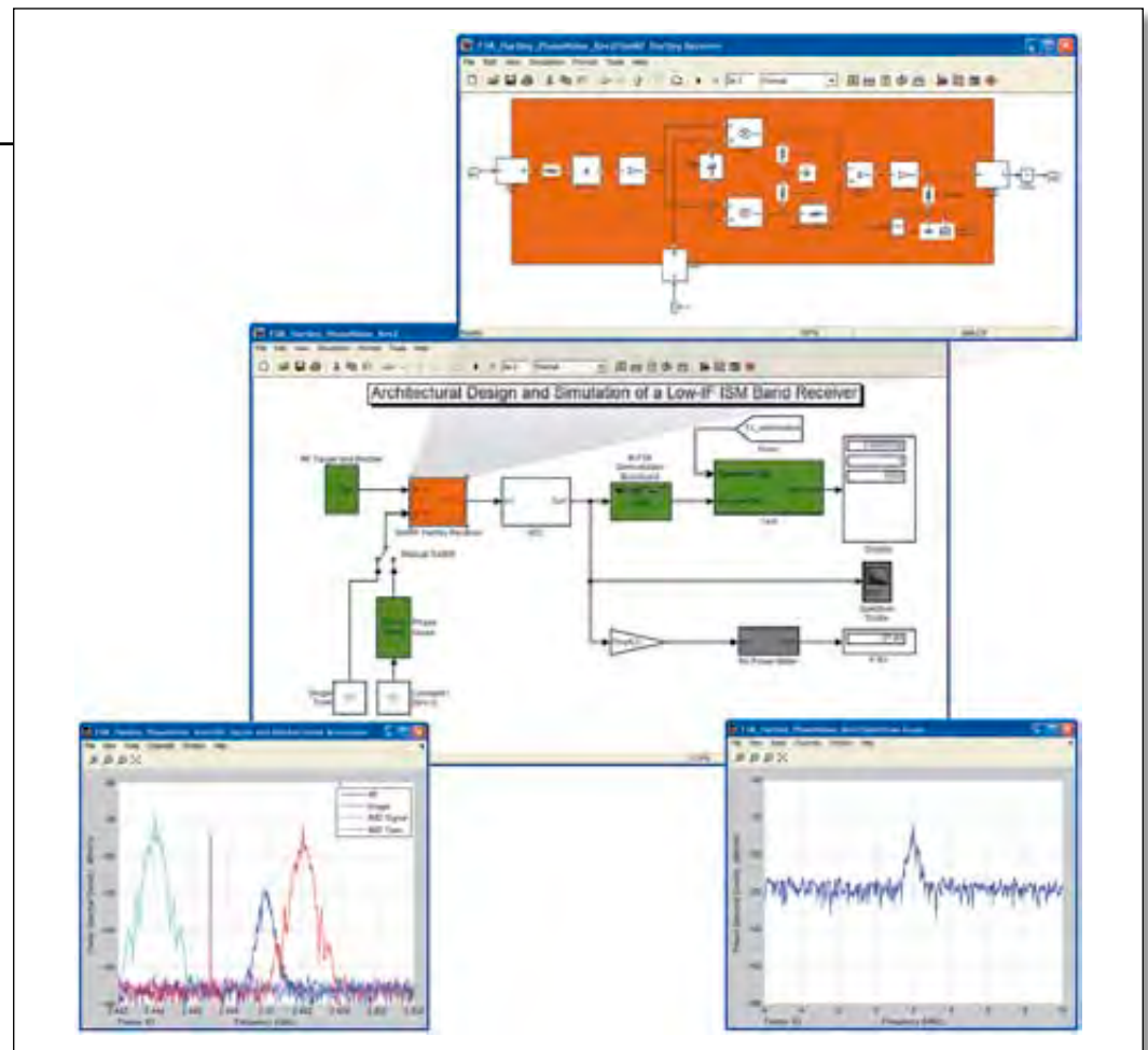
Bild 4: Systemebenen-Modell eines ISM-Band-Empfängers in SimRF (Mitte), eines Hartley-Empfänger-Subsystems mit niedriger ZF (oben) und eine Darstellung des Empfangssignals am Empfänger-Ausgang.
