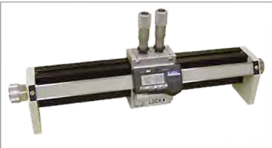
Bild 12: Mechanischer Präzisions-Tuner, Slugs einzeln einstellbar Fa. Maury
