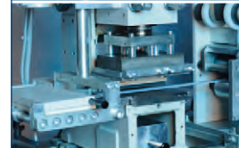
Stanzteilherstellung mittels Hochleistungsstanzmaschine
