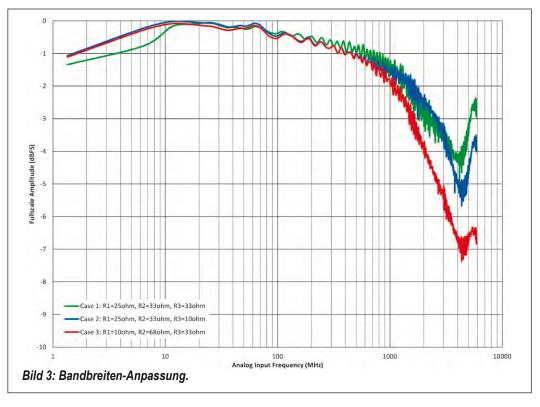
die gemessenen Parameter, die zur Entwicklung des Frontend-Netzwerks erforderlich sind. Die Anpassung hier ist das beste Ergebnis für alle beteiligten Parameter, wobei in diesem Fall eine Bandbreite von über 2,5 GHz benötigt wurde. Dies begrenzt die Wahl auf die Fälle 1 und 2 (Bild 3).
